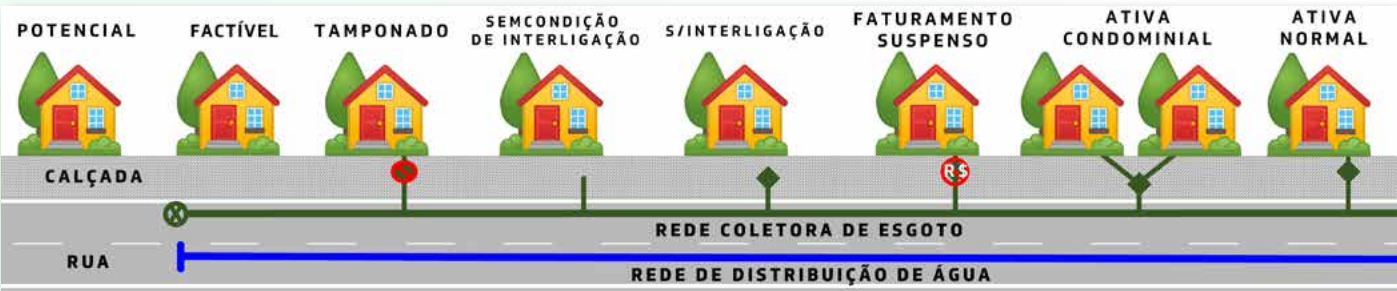
Figura 2: Situações de Ligação de Esgoto
