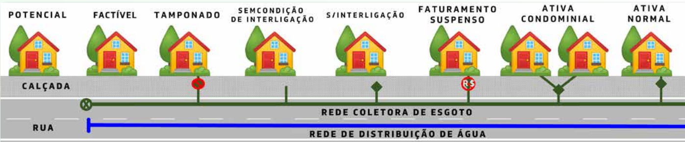
Figura 2: Situações de Ligação de Esgoto
