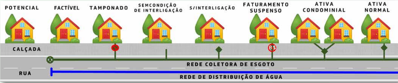
Figura 2: Situações de Ligação de Esgoto
