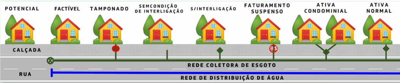
Figura 2: Situações de Ligação de Esgoto
