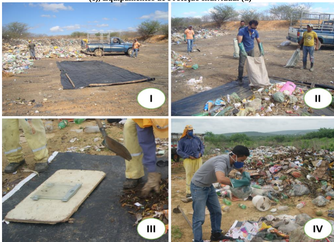
Figura 7.1 – Materiais usados no processo de gravimetria: Lona (a), Sacos plásticos (b), Balança (c), Equipamentos de Proteção Individual (d)
