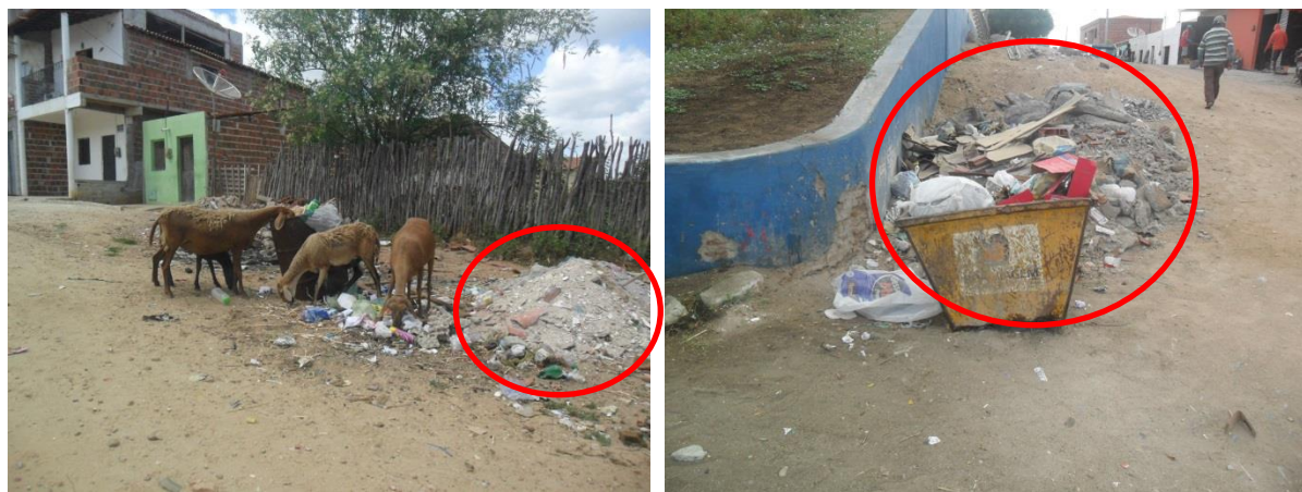
Figura 17.16 – RCD disposto de modo inadequado.
