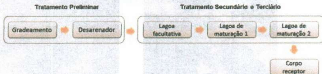
Figura 145: Fluxograma do processo de tratamento – ETE Jaguaribe Sede.
