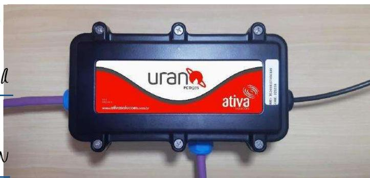
**Figura 04 – Modelo de telemetria para retificador de sistema de proteção catódica**
